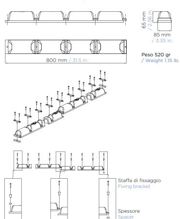
All'estremità della sequenza di elementi si può utilizzare uno spessore che si interpone tra parabordo e supporto At the end of the sequence of elements, we recommend to insert a spacer between the fender and the support
